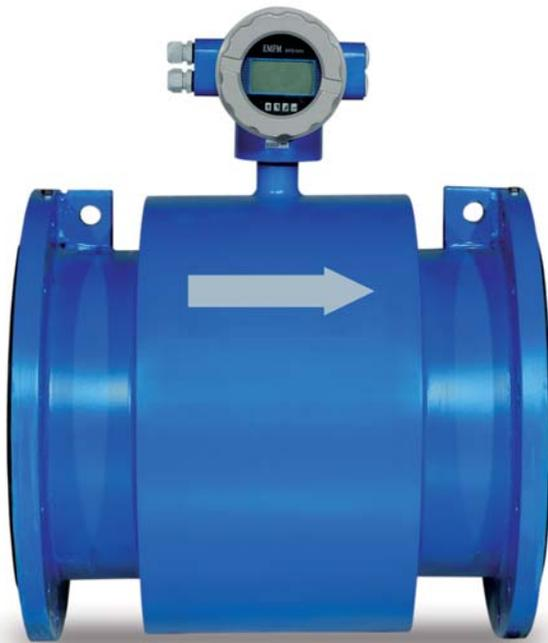
El medidor electromagnético HIDROMAG es un sistema modular que permite la medición, transmisión y totalización de caudal de cualquier tipo de líquidos. Está constituido por el tubo de medida que va colocado en la conducción y el convertidor electrónico que puede ser montado sobre el tubo de medida o separado. La totalización de fluidos, en este medidor, está basada en el principio de Faraday.
