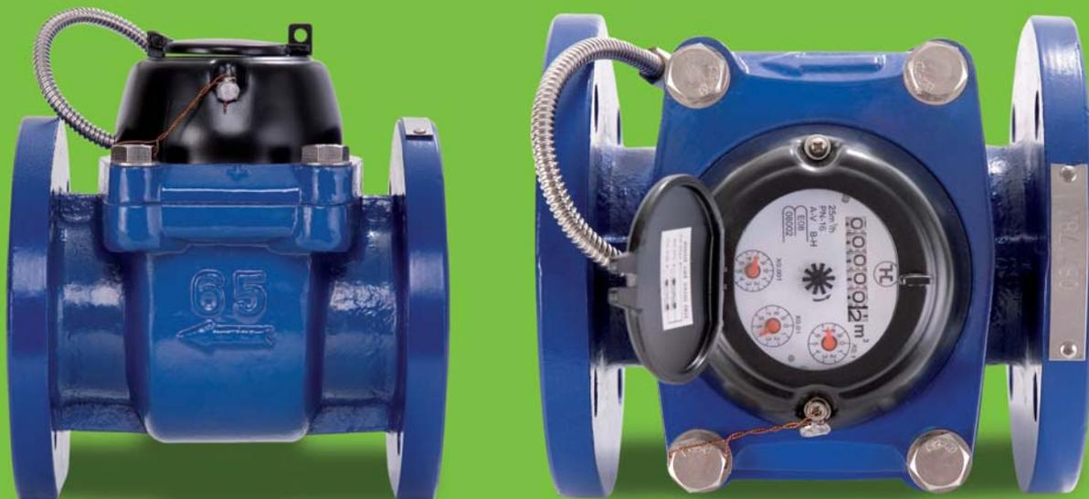
Los contadores woltmann son medidores de avanzado diseño. Su funcionamiento se basa en una turbina o hélice situada en la línea de flujo del agua. El giro de la hélice se transmite mediante transmisión magnética a través de un eje y engranajes hasta un cabezal que acumula en su totalizador el volumen de agua que ha circulado por el contador.
